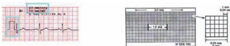
Figura 8. Registro en papel milimetrado, la amplitud 10 mm/ mv se aparece como una marca rectangular al inicio.
